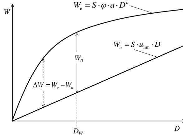
Esprimendo matematicamente la condizione di massimo, ossia derivando rispetto alla durata  $D$  la differenza  $\Delta W = W_e - W_u$ , si ricava la durata critica  $D_w$  per l'invaso di laminazione e di conseguenza il volume di laminazione  $W_0$ :
