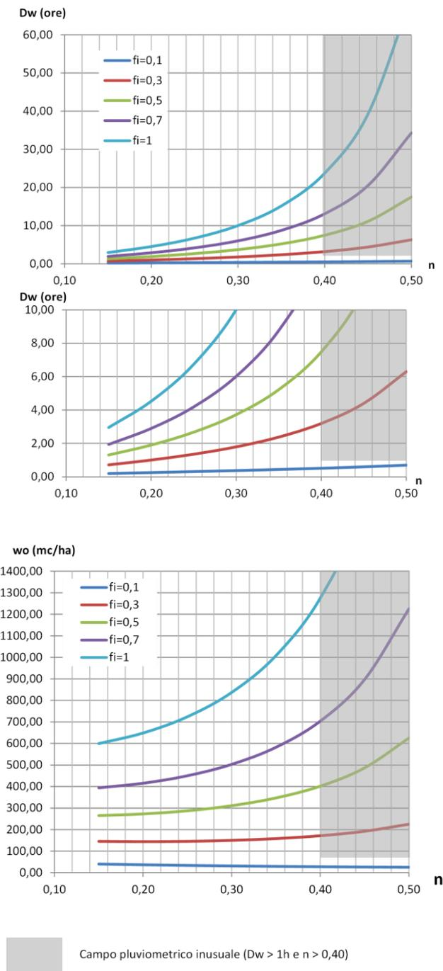
Figura 7 – Grafici della durata  $D_w$  (eq. 12'') e del volume specifico critico di invaso  $w_o$  (eq. 13'') in funzione di  $n$ , per  $a=80$  mm/ora e per  $u = 10$  l/s per ettaro
