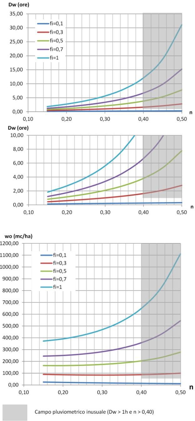
Figura 6 – Grafici della durata  $D_w$  (eq. 12'') e del volume specifico critico di invaso  $w_o$  (eq. 13'') in funzione di  $n$ , per  $a=60$  mm/ora e per  $u = 10$  l/s per ettaro
