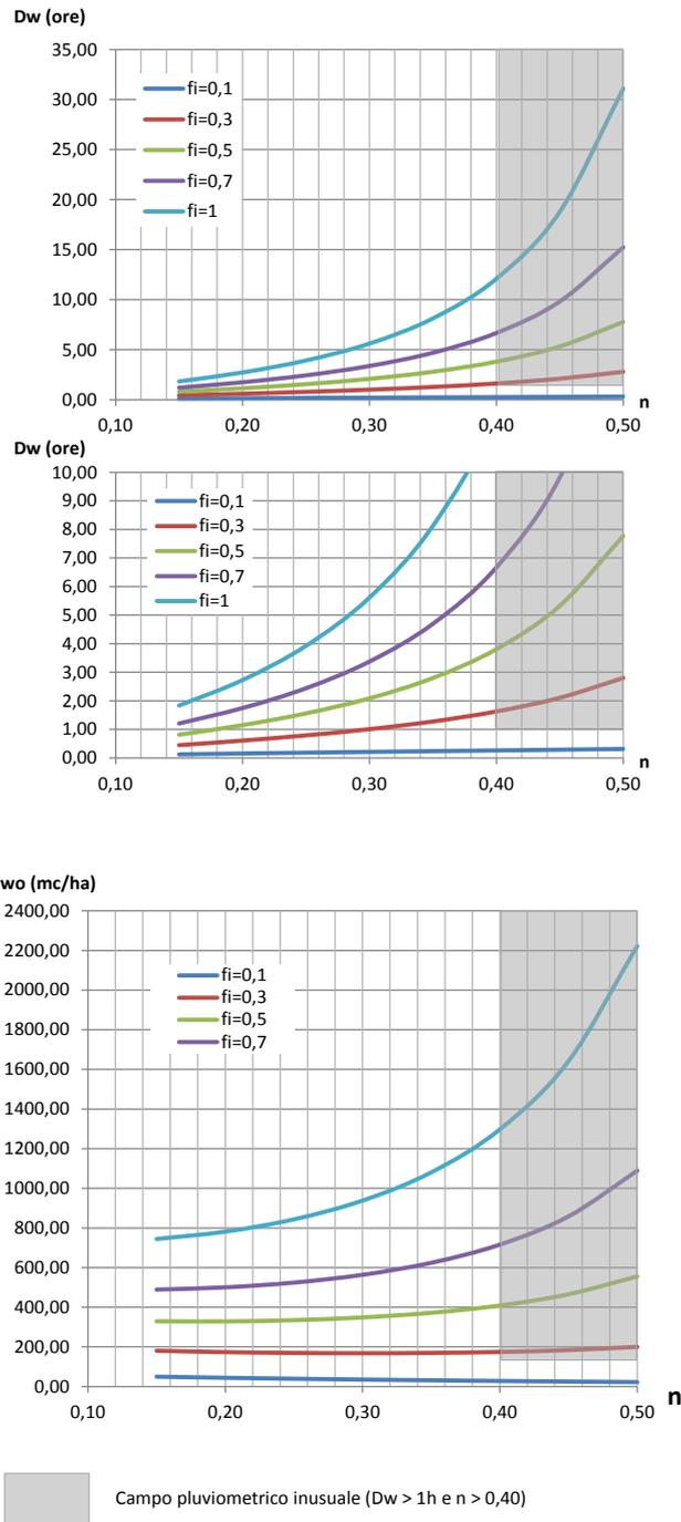
Figura 12 – Grafici della durata  $D_w$  (eq. 12'') e del volume specifico critico di invaso  $w_o$  (eq. 13'') in funzione di  $n$ , per  $a=100$  mm/ora e per  $u = 20$  l/s per ettaro
