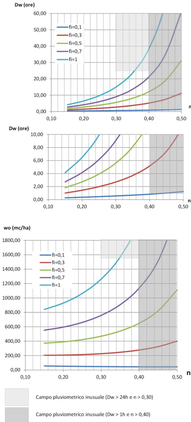
Figura 8 – Grafici della durata  $D_w$  (eq. 12'') e del volume specifico critico di invaso  $w_o$  (eq. 13'') in funzione di  $n$ , per  $a=100$  mm/ora e per  $u = 10$  l/s per ettaro
