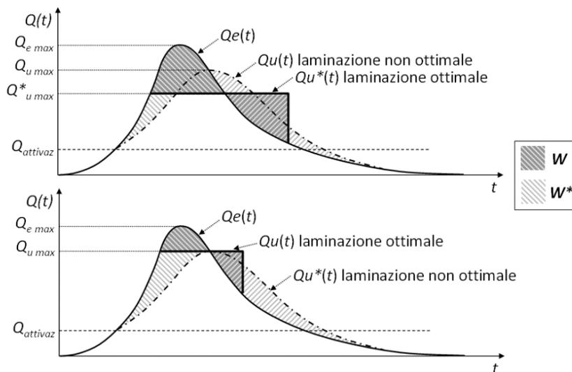
Questo schema di regolazione teorica è raggiungibile in modo approssimato quando l'uscita è governata da un impianto di sollevamento avente portata  $Q_{u max}$  o con opportuni automatismi di regolazione degli scarichi, come i regolatori di portata che modificano la luce d'efflusso in funzione del battente in modo da mantenere costante la portata uscente  $Q_{u max}$ .
