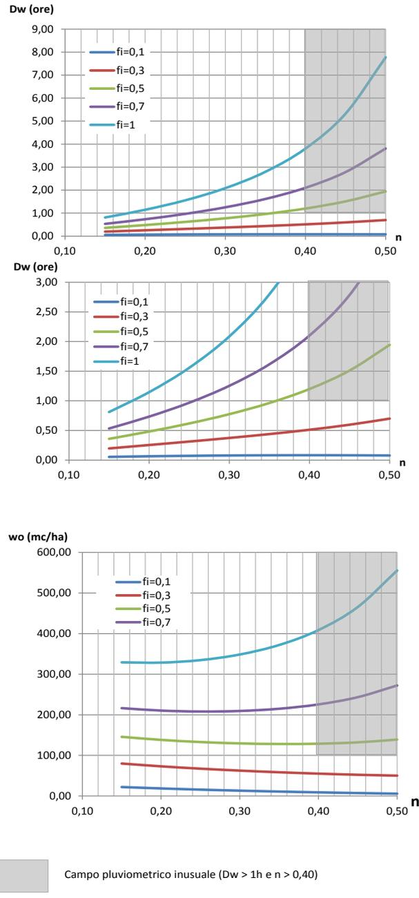
Figura 10 – Grafici della durata  $D_w$  (eq. 12'') e del volume specifico critico di invaso  $w_o$  (eq. 13'') in funzione di  $n$ , per  $a=60$  mm/ora e per  $u = 20$  l/s per ettaro
