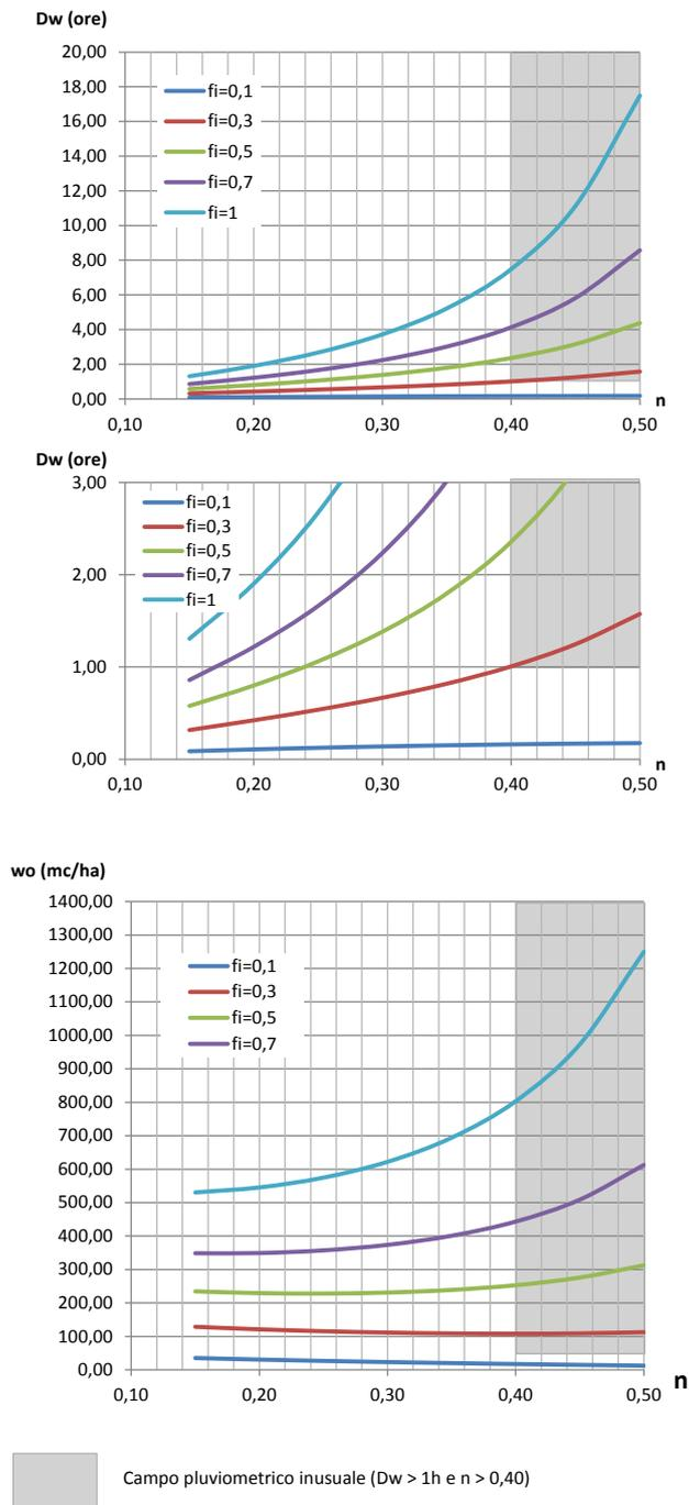
Figura 11 – Grafici della durata  $D_w$  (eq. 12'') e del volume specifico critico di invaso  $w_o$  (eq. 13'') in funzione di  $n$ , per  $a=80$  mm/ora e per  $u = 20$  l/s per ettaro
